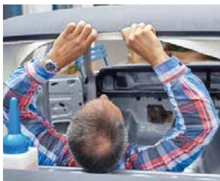
...mit dem Verkleben am oberen Heckscheibenausschnitt. Dazu spannt er den Stoff und drückt...
