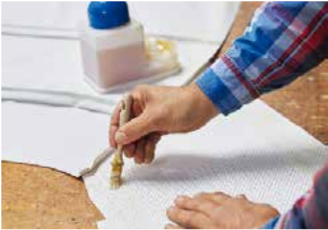
Mit einem Pinsel trägt Treber den Kleber auf den Stoff auf und lässt ihn einige Minuten anziehen
