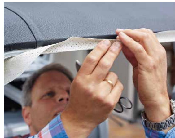
...die Klebestellen von der Mitte ausgehend an. Das gleiche Spiel folgt anschließend vorne
