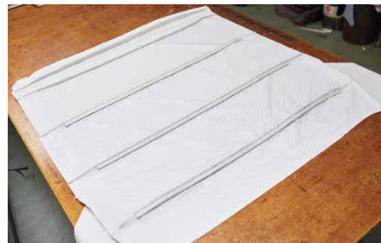
Voilà, der fertige Dachhimmel: Die Schlaufen und Nähte sind nur auf der Rückseite zu sehen
