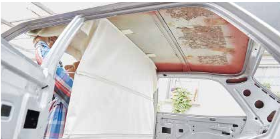
Zuerst hängt der Profi die mittlere Spannstange mitsamt dem neuen Himmel ein. Dann arbeitet er sich Stange um Stange nach vorne und hinten. Wichtig ist, dass der Himmel längsseits genau mittig sitzt
