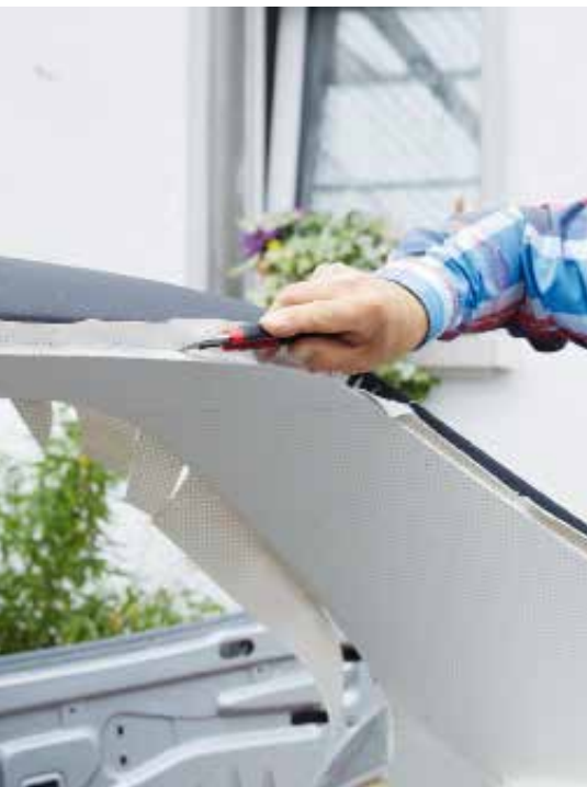
Der letzte Arbeitsschritt ist das Entfernen des überschüssigen Materials mit einem Messer
