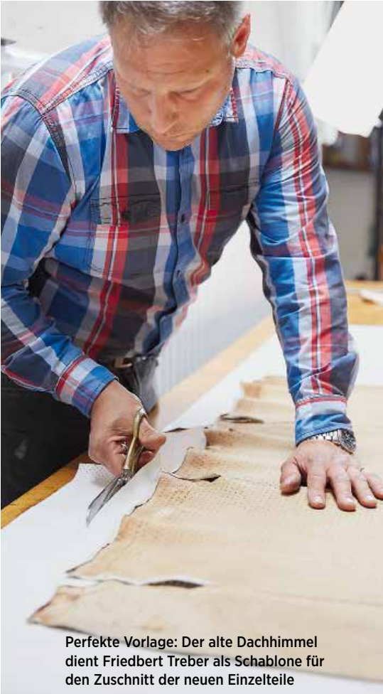
Rundherum gibt der Profi einige Zentimeter Materialzugabe
