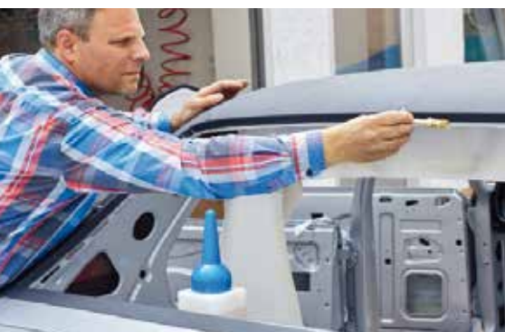
Erst jetzt streicht er auch die karosserieeinseitigen Kontaktflächen mit Kleber ein. Treber beginnt...
