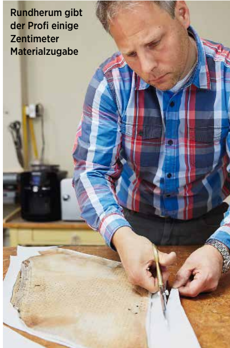
Am alten Himmel lassen sich Details wie die seitlichen Einschnitte recht gut erkennen
