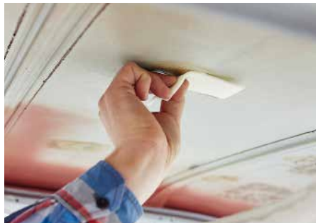
Bevor der Himmel an seinen Platz kommt, klebt der Experte noch kleine Schaumstoffstreifen...
