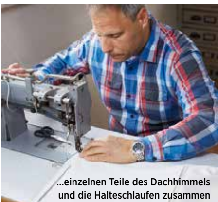
Mit einer älteren, aber äußerst robusten Industriemaschine näht der Profi die...
